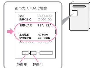
表示のガス種および電源が一致しないと、不完全燃焼による一酸化炭素中毒になったり、爆発着火でやけどしたり、機器が故障する場合があります。
