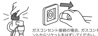
ガスコンセント接続の場合、ガスコンセントからソケットをはずしてください。
