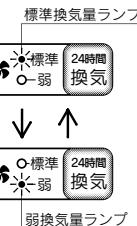
弱換気量ランプが点灯し、弱換気量で換気運転を行います。
