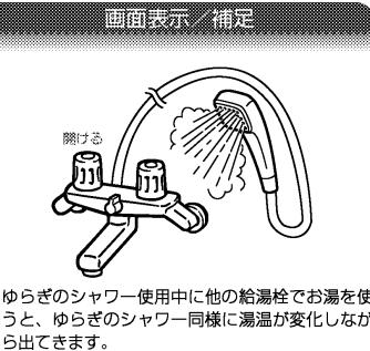
※ゆらぎのシャワー使用中に他の給湯栓でお湯を使うと、ゆらぎのシャワー同様に湯温が変化しながら出でます。
