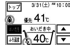
※台所リモコンで操作した場合は、約1分間ポンプ運転した後、ふろ設定温度までおいだきします。なお、ふろ温度がふろ設定温度以上の場合は、約1分間ポンプ運転後に停止します。
