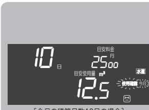
⑭ 再度 **選択** を押すと、先月の水道使用量、目安料金の実績を表示します。
