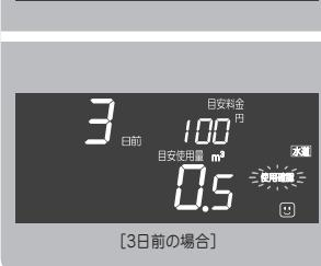
⑬ 再度 **選択** を押すと、今月の水道使用量の目安料金の実績を表示します。
