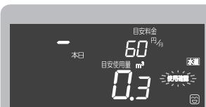
⑫ **△** で過去7日間の水道使用量、目安料金の実績を表示します。
