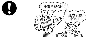
ゴム管は、検査合格またはJISマークの入っているガス用ゴム管で接続してください。ガス用以外は耐久性に欠けガス漏れの原因になります。
