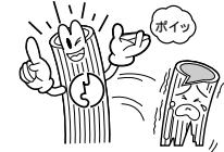
古くなると、ひび割れや差し込み口がゆくなつてガス漏れの原因になりますので、ときどき取り替えてください。
