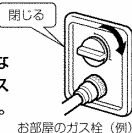
お部屋のガス栓 (例)
