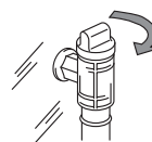
〔ガス元栓の例〕
