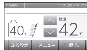
①給湯温度、台所優先です 台所リモコンで記憶していた給湯温度を表示し、浴室リモコンから優先が消え、優先の緑も消えます。
