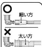
機器への接続はガスコードの細い方を接続してください。
