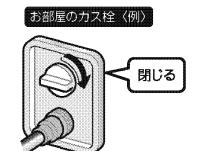
(つまみのないガス栓の場合は、ガス栓からガスコードを外してください。)
