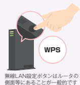
無線LAN設定ボタンはルータの側面にあることが一般的です
