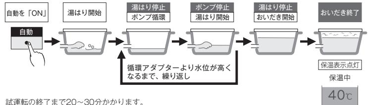
9 表示画面に保温表示が点灯すれば試運転完了
