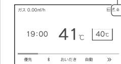
・給湯設定温度を60°Cに設定すると、音声で『熱いお湯が出来ます』『給湯温度を60°Cに設定しました』とお知らせして、表示画面に【高温】を表示して注意を促します。
