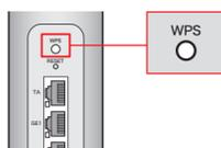
自動的に接続が行われ、動作中は本装置前面LEDのWPSランプが点滅します。接続が完了すると、「接続されました」と表示されます。
