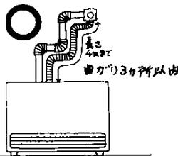
3. 給気ホース・排気管は確実に接続抜け止め・固定されていますか。
