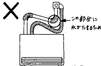
2. 延長給排気の場合、給気ホース・排気管の長さは4m以内で、曲がり部分が3箇所以内になっていますか。これ以上長く伸ばしたり、曲がり箇所を多くしますと、燃焼用空気が不足し不完全燃焼の原因となります。
