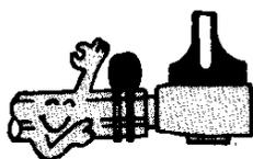
ガス用ゴム管もときどき点検し、接続は確実に
