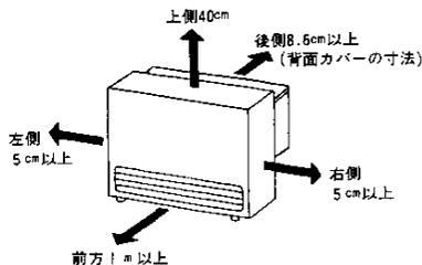
2. 床面の不安定な場所や燃えやすいものの上に据付けられていませんか。別売部品の敷板をお使いください。特に前に傾いて据付けられていたり燃えやすいものの上に据付けられていますと、温風により変色・変質することがあります。
