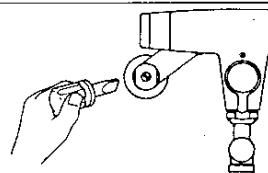
ドライバーで湯側・水側の止水栓を開じてください。
