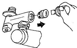
ドライバーを溝に差しこみストレーナをゆるめて取出してください。
