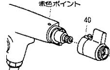
温度調節ハンドルが回らないように注意してキャップ・小ねじをはずして温度調節ハンドルを抜きとってください。
