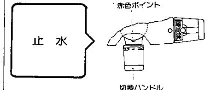
温度調節ハンドルを回してお好みの湯温を赤色ポイントに合わせてください。ダイヤルの数字は湯温を示す目安としてください。
