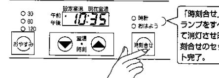
「時刻合せ」スイッチを押した時点で午前10時35分0秒からスタートし、表示部のコロンが点滅し時計が動きます。
