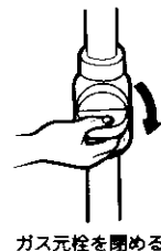
ガス元栓を閉める
