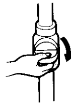
ガス元栓を閉める
