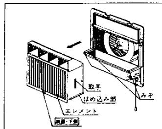
③エレメントの清掃は、掃除機で表面のゴミ、ホコリを吸収してください。掃除機は、長いハケ付きのものを使用してください。
