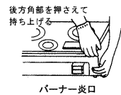
後方角部を押さえて持ち上げる
