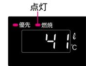
サーモ付混合水栓の場合は、水栓側の温度設定を最も高温にしてください。
