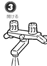
※リモコンの運転スイッチが「切」の状態の水を使用する場合、混合水栓は必ず「水」の位置で使用してください。「湯」の位置で水を流すと、機器内が結露して点火不良や故障の原因になります。
