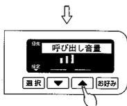
**6** 再度[選択]スイッチを押すと、「設定されました」とお知らせして設定が完了します。
