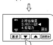
**5** 再度[選択]スイッチを押します。このとき **電燈** 表示が点滅してお知らせします。
