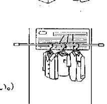
4. 湿風の吹出角度によって乾燥時間が異なります。湿風が洗濯物にうまく当たるように可動ルーバーで上下・左右を調整してください。
