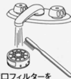
掃除後、循環口フィルターを 元のように取り付けます。
