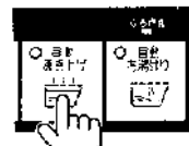
自動沸き上げランプ、ふろ燃焼ランプ消灯
