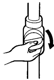
ガス元栓を閉める
