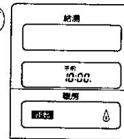
熱源機の暖房燃焼ランプが点灯し、メインリモコンの「運転」と「」が表示され暖房運転を始めます。
