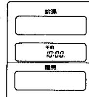
熱源機の暖房燃焼ランプおよびメインリモコンの「運転」と「」が消えます。
