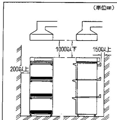
※可燃性の壁にステンレス板等を貼り付けてご使用の場合でも上図のように設置してください。
