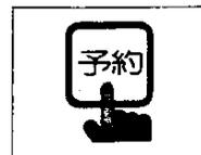
※テスト着火動作で正常に着火しなかった場合、ブザーがなり、「E」の表示が点滅します。ガス元せんを確認してもう一度 **予約炊飯スイッチ** を押してください。
