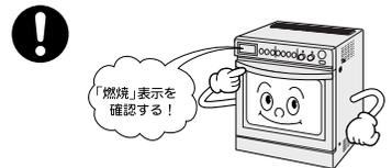
ガスオープン使用時は、「燃焼」表示の点灯で点火を確認、使用後は「燃焼」表示の消灯で消火していることを確かめてください。
