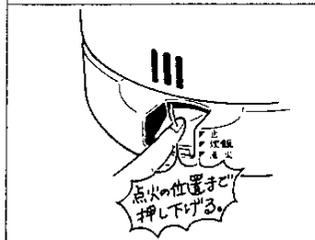
●炊飯レバーから手を離れたときに火が消えた場合は、押し下げ時間と押し下げ力の不足です。もう一度同じ操作を繰り返し、炊飯レバーを押している時間を前回より、強く長くしてゆっくり手をはなしてください。
