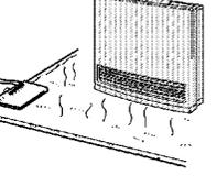
機器の重みで、電気カーペット・温水マットが故障する場合があります。また、電気カーペットや温水マットの熱で機器が正しい制御をしないことがあります。
