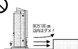
温風があたる部分の変色やひびわれのおそれがあります。必ず機器は水平な所（確実に設置できる所）に設置して使用してください。
