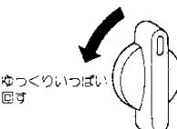
①器具栓つまみを途中で止めずに<sup>(止)</sup>の位置から左へ<sup>(点火)</sup>の位置までゆっくりいっぱい回すと「カチッ」と音がして点火します。
