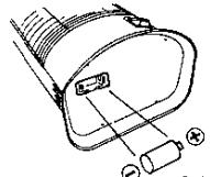
単2 1.5Vの乾電池を使用し確実にセットしてください。
