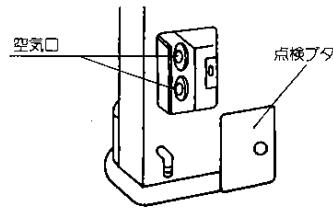
空気口は点検プラタをはずし(ネジで固定してあります)掃除してください。
