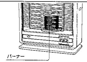
③点火レバーより手を離してからバーナーの着火(バーナー表面が赤熱します)を確かめてください。
