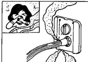
ゴム管はガス用ゴム管を用い折れたりねじれたりしないように、できるだけ短かくし、器具の下を通したり、器具に触れたりしないようにしてご使用ください。
