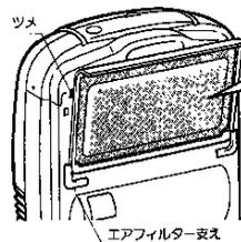
エアフィルター上部を持ち、下部をエアフィルター支えに差し込み、ツメを後板の角穴に確実にセットしてください。
