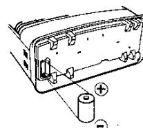
単1 1.5Vの乾電池を使用し確実にセットしてください。
