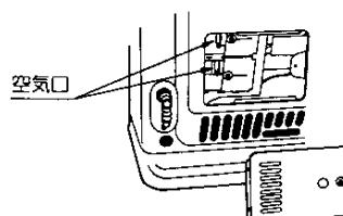
空気口は点検蓋をはずし(ねじで固定されています)掃除してください。
