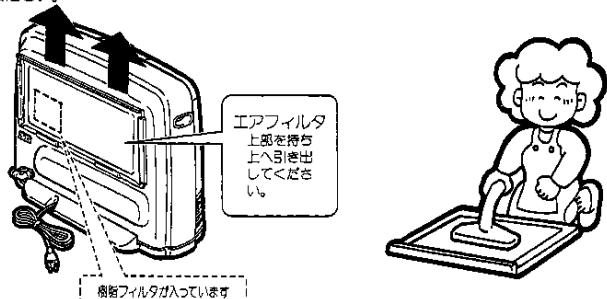
●エアフィルタがほこり詰りをしたり、温風吹出しおに障害物があつたりしたときは、器具内が異常に過熱します。フィルタサイン点滅後も運転を続けますと、器具が自動的に運転を停止することがあります。
