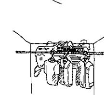
4. 温風の吹出角度によって乾燥時間が異なります。温風が洗濯物にうまく当たるように可動ルーバーで調整してください。
