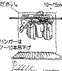
2. 衣類は温風の出る向きと平行になるよう干します。また、衣類と衣類のあいだにむらなく温風が行きわたるように少しづき間をあけて干します。物干しバーには、洗濯物をかけたハンガーを10~15cmの間隔で吊下げてください。ハンガーの数は物干しバー1本あたり7~10本が適当です。ハンガーの数が多くなると乾燥時間が長くかかります。
