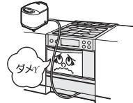
ガスコード、ガス用ゴム管の引き回しは炎に直接触れる可能性のある場所や、高温に加熱される場所はさけてください。
