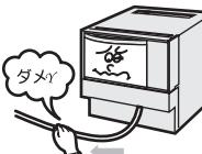
接続されたガスコード及びガス用ゴム管及び電源コードは、引っ張らないでください。ガス漏れや故障の原因となります。
