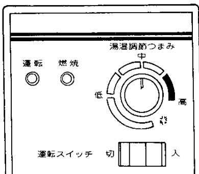
①運転スイッチを「入」にして、運転ランプが点灯するのを確かめてください。約40秒ほどで、燃焼ランプが点灯します。
