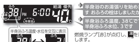
燃焼ランプ[赤]が点灯し、湯を表示します。
