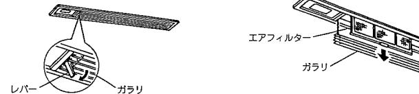
2 矢印方向にラッチをはずして、フィルター枠を倒します。
