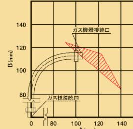
※斜線の範囲がガス機器接続口の接続可能範囲である。
