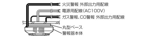
④カバー取付ネジを締め、ベースにベースカバーを元通りに取り付ける。
