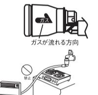
③この取扱説明書に記載の、2.正しい使い方 を守りガス栓やガス機器へ確実に接続する。不完全な接続はガス漏れの原因になります。
