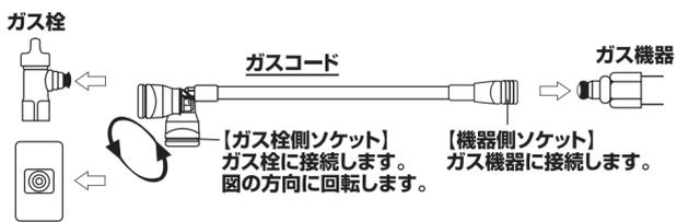
ガスコードはガス栓とガス機器を接続するためのものです。ガス栓側ソケットは回転しますので、状況によりガスコードに負荷のかからない角度でご使用ください。
