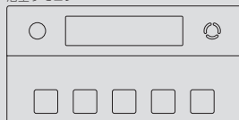
浴室リモコン
