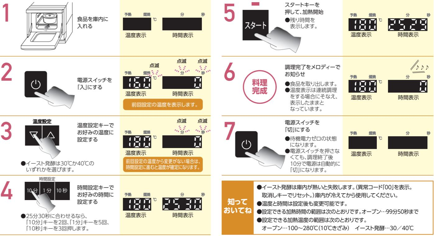
●イースト発酵は庫内が熱いと失敗します。(異常コード「00」を表示。取消しキーでリセット。)庫内が冷えてから使用してください。
