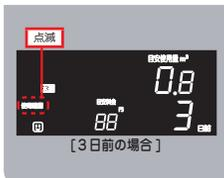
13 再度
