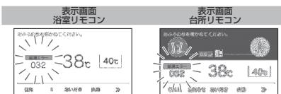
以下の故障表示が点滅した場合は、表中の「処置」をしてみてください。
