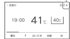
・給湯設定温度を60°Cに設定すると、音声で『熱いお湯が出ます』『給湯温度を60°Cに設定しました』とお知らせして、表示画面に【高温】を表示して注意を促します。
